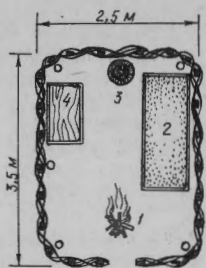
Житлове приміщення для пастухів. С. Хомичі Любомльського району Волинської області: 1. Вогнище. 2. Ліжко («тапчан»); 3. Бочка для молока. 4. Скриня.
